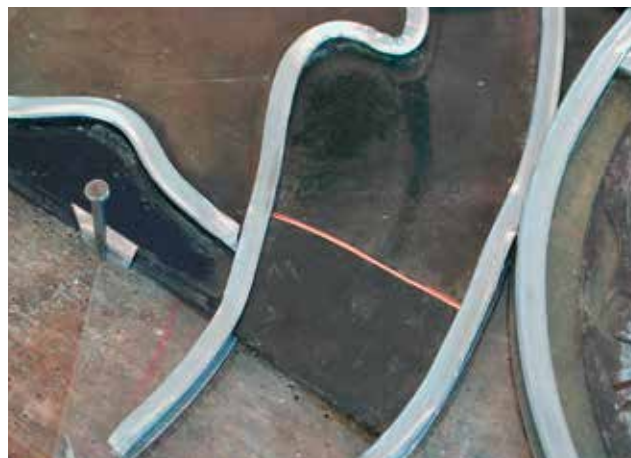
Tiffany avant soudure. Fragments avant soudure, placés dans un panneau en cours de sertissage.
