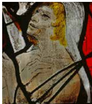
Corrosion des verres autour de la grisaille et sur la grisaille. Baie 119, église Saint-Germain-l'Auxerois, Paris
