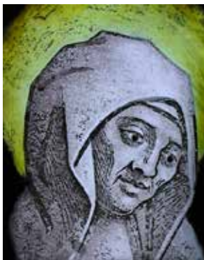
Corrosion des verres autour de la grisaille et sur la grisaille. Baie 119, église Saint-Germain-l'Auxerois, Paris
